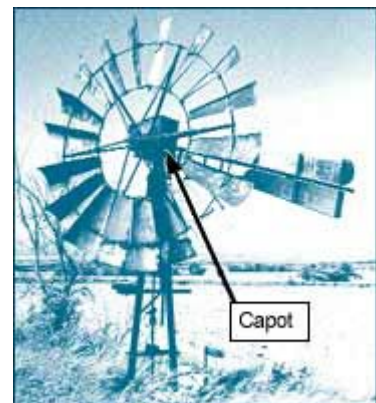
Le capot de cette éolienne "commune" protège son mécanisme (Razès, Aude).
