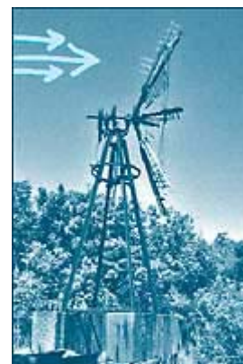
Une "préolienne" du système Dellon avec un système d'orientation de type "aval" : les flèches indiquent la provenance du vent (Agathois, Hérault).
