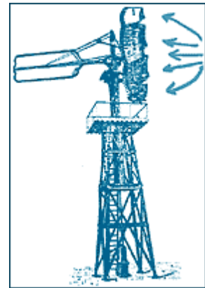
Une éolienne "américaine" à "sections mobiles" (fin xix e siècle) : les sections de pales pivotent et s'effacent vers l'arrière suivant la force du vent.
