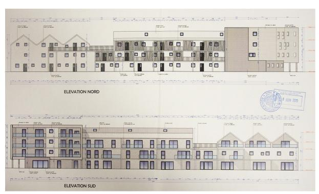
Figure 77 : élevations du bâtiment des *ToitMoiNous* (Noémie Kieken arch. 2015) montrant le principe de juxtaposition et la transition d'échelles d'est en ouest
