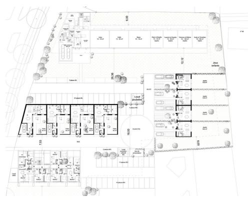
Figure 74 : plan de RDC de l'opération *Plurielle* (Noémie Kieken arch. 2015). La «placette» centrale est en fait une aire de retournement
